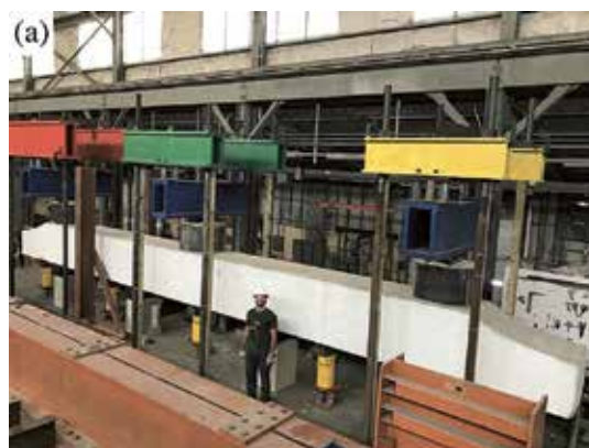
5 Testopstelling 60 jaar oude onderslagbalk
