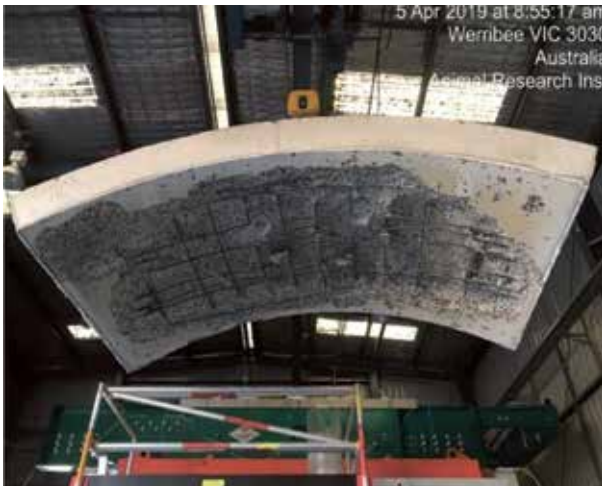
3 Proefstuk na een brandproef
