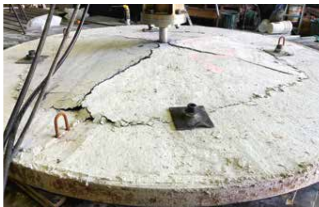
foto 5 Proefstuk (diameter 2400 mm) met een belasting uit het vlak; ontwikkeling van de vloeilijnen zichtbaar
